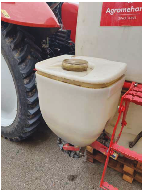
Slika 5. Uređaj za punjenje sredstvom za zaštitu bilja Figure 5. Device for filling with plant protection agent
