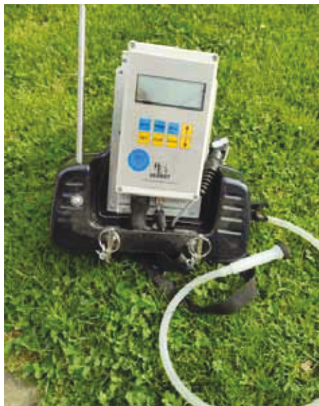
Slika 11. Uređaj za mjerenje kapaciteta sapnice Figure 11. Device for measuring nozzle capacity
