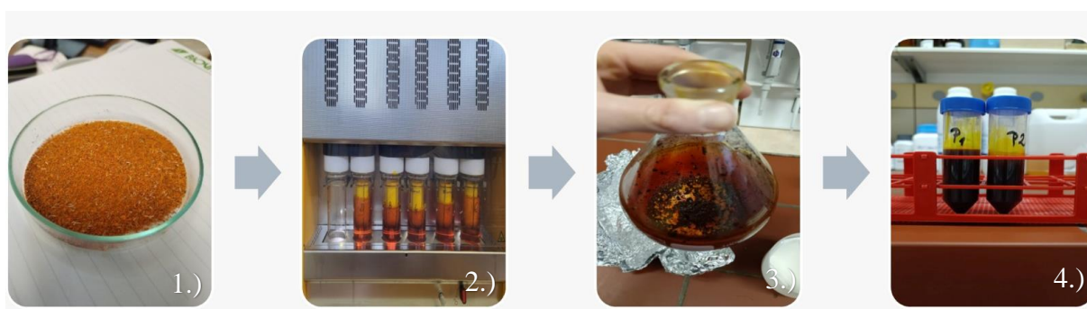
Slika 3.1.1. Shematski prikaz procesa ekstrakcije sljedećim redoslijedom: 1.) prah cvijeta kadifice; 2.) ekstrakcija u Soxhlet ekstraktoru; 3.) ekstrakt kadifice nakon uparavanja etanola; 4.) ekstrakt otopljen u suncokretovom ulju
