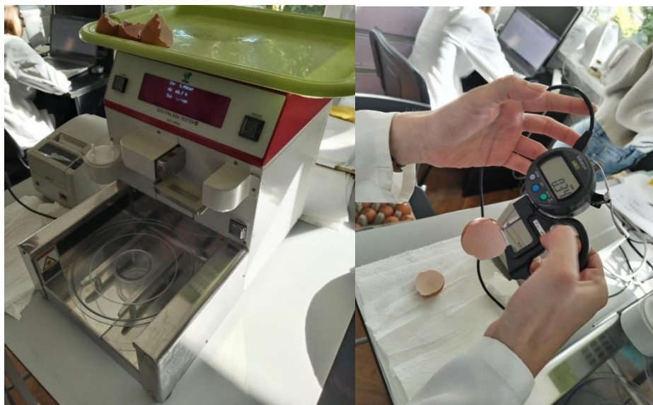
Slika 3.5.1. Instrumentalno određivanje kvalitete jaja pomoću Digital Egg Testera (lijevo); određivanje debljine ljuske jaja digitalnom pomičnom mjerkom (desno)
