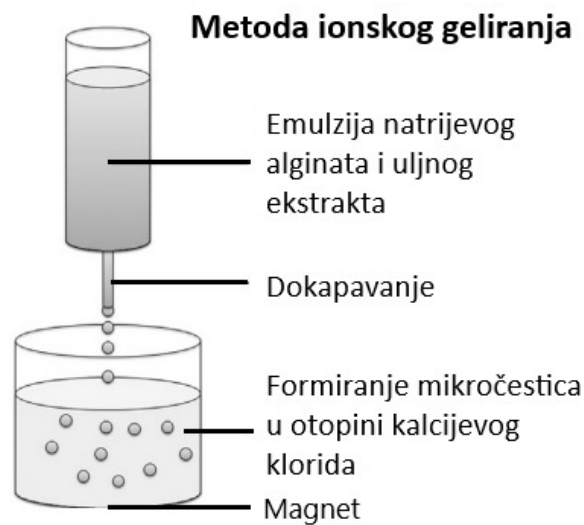
Slika 2.8.1. Shema ionskog geliranja (Vemmer i Patel, 2013.)
