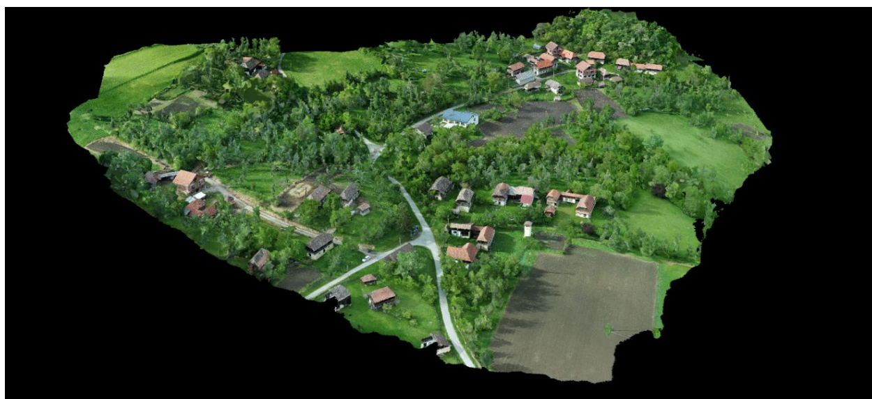
Slika 14. Konačna verzija 3D modela naselja Gorička nakon rezanja ruba
