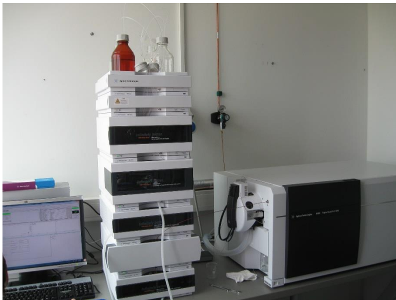
Slika 3.3.1. tekućinski kromatograf (Foto: Mihaela Grubelić, Eurofins Croatiakontrola d.o.o.)
