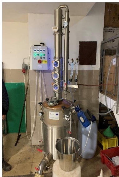
Slika 2 Složeni destilacijski uređaj, izvor fotografije: autor
