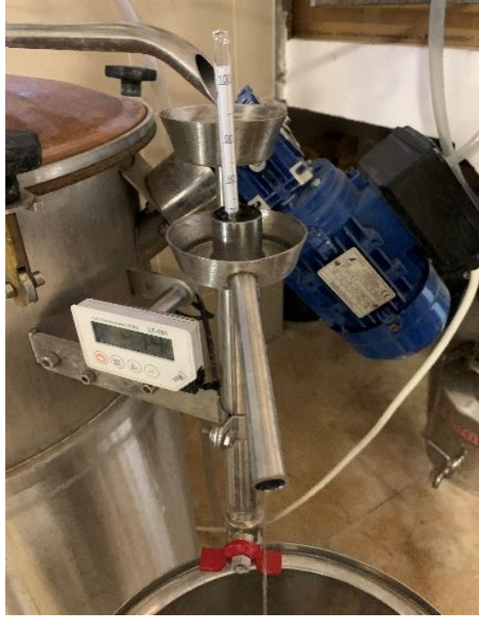
Slika 6 Mjerenje alkoholne jakosti destilata na izlazu iz destilacijskog uređaja, izvor fotografije: autor
