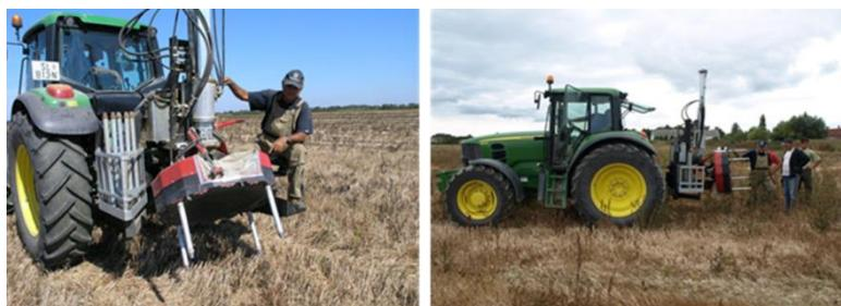
Slika 8: Prikupljanje uzorka na terenu hidrauličnom poluautomatskom sondom nove generacije
