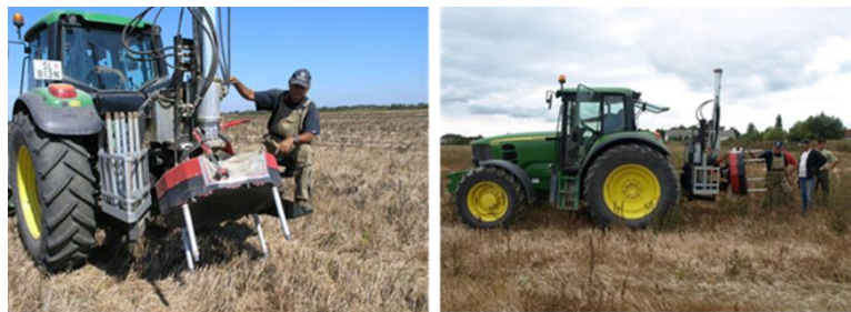
Slika 8: Prikupljanje uzoraka na terenu hidrauličnom poluautomatskom sondom nove generacije
