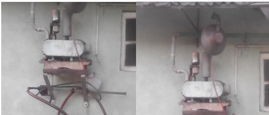
Slika 13. Podtlačna pumpa i filter zraka (Foto: Švub)
