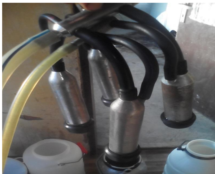
Slika 6. Muzne jedinice (Foto Švub)
