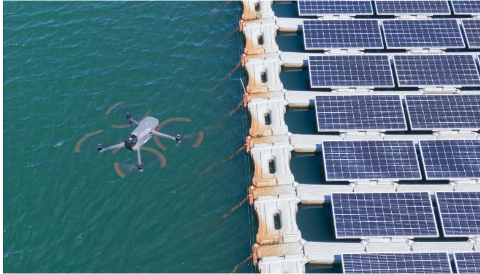
Slika 5. Korištenje drona kao pomoć pri održavanju
