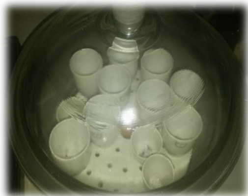
Slika 11. Spaljeni uzorci na hlađenju u eksikatoru (Slikala: Martina Pejić)
