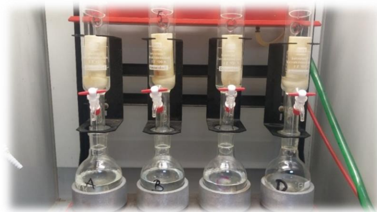
Slika 17. Određivanje udjela masti pomoću Soxhlet ekstraktora (Slikala: Martina Pejić)
