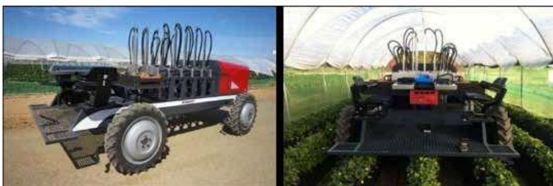
Slika 38. Robotski berač jagoda (Jatoi et al. 2017).
