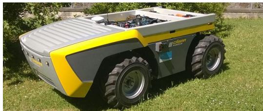
Slika 43. Obavljanje općih poslova u voćnjaku i vinogradu robotom tipa Cäsar, (Ćosić, 2021).
