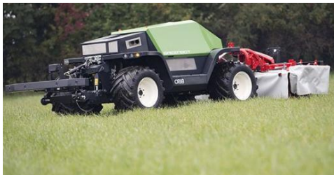
Slika 41. Košnja livada, voćnjaka i vinograda robotom tipa Greenbot, (Ćosić, 2021).
