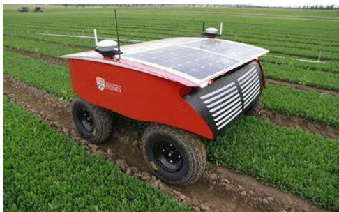
Slika 42. Kemijsko suzbijanje korova robotom tipa Rippa, (Ćosić, 2021).
