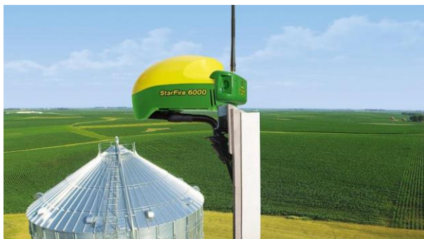
Slika 22. RTK statička bazna stanica (Ćosić, 2021).
