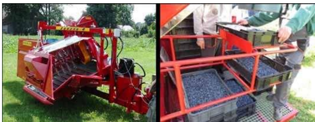
Slika 29. Kombajn za berbu borovica (Jatoi et al. 2017).
