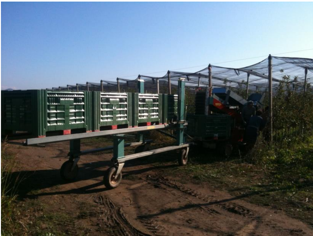
Slika 26. Samokretna platforma „Pluk-O-Trak Junior“ (Sito et al. 2016).
