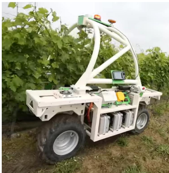
Slika 44. Prorjeđivanje lišća u vinogradu robotom tipa Naio (Ćosić, 2021).
