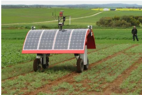
Slika 40. Kontrola zdravlja usjeva robotom tipa Ladybird (Ćosić, 2021).
