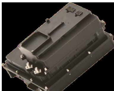
Slika 18. NanoSAR B - primjer radarske kamere (Krevh, 2018).
