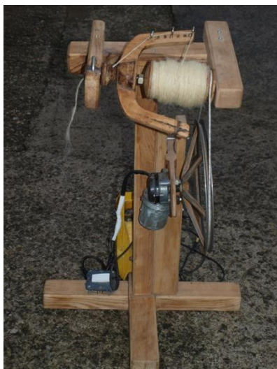
Slika 5. Električni kolovrat za pređenje vune
