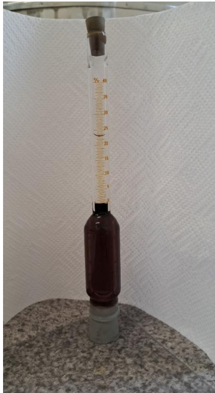
Slika 4.12. Određivanje udjela mliječne masti Van Gulikovom butirometrijskom metodom
