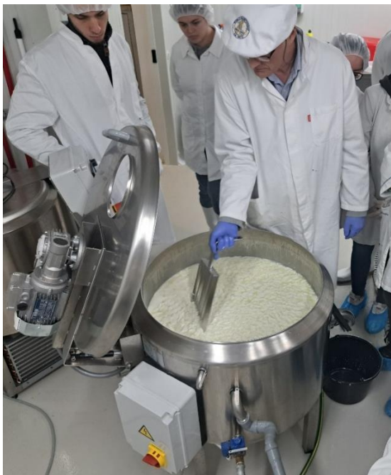
Slika 4.1. Proces rezanja gruša sirarskom harfom
