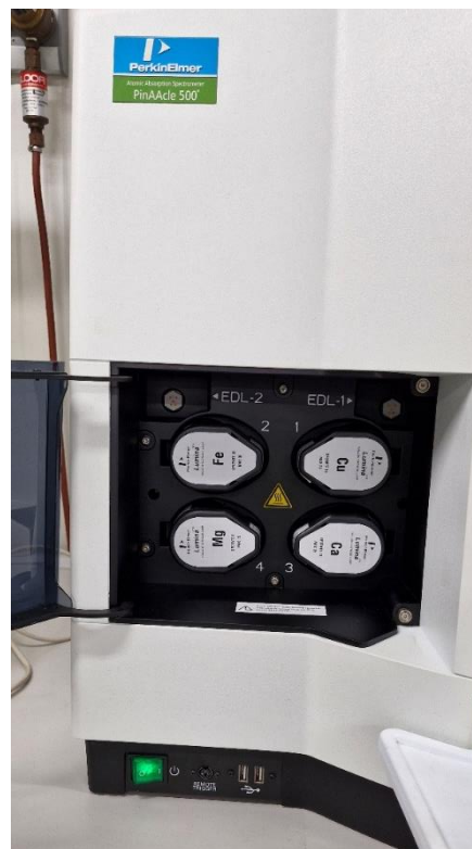
Slika 15. Atomski apsorpcijski spektrometar (lijevo) i lampe (desno)
