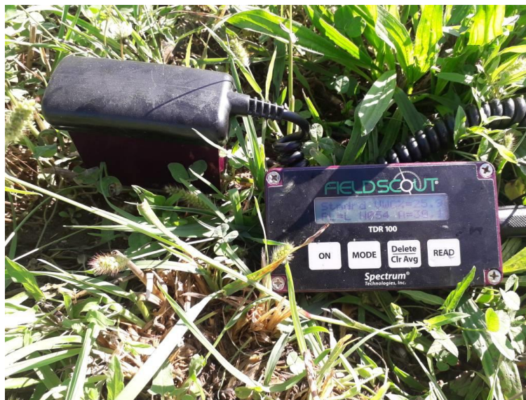
Slika 4.1. TDR metoda mjerenja vode u tlu
