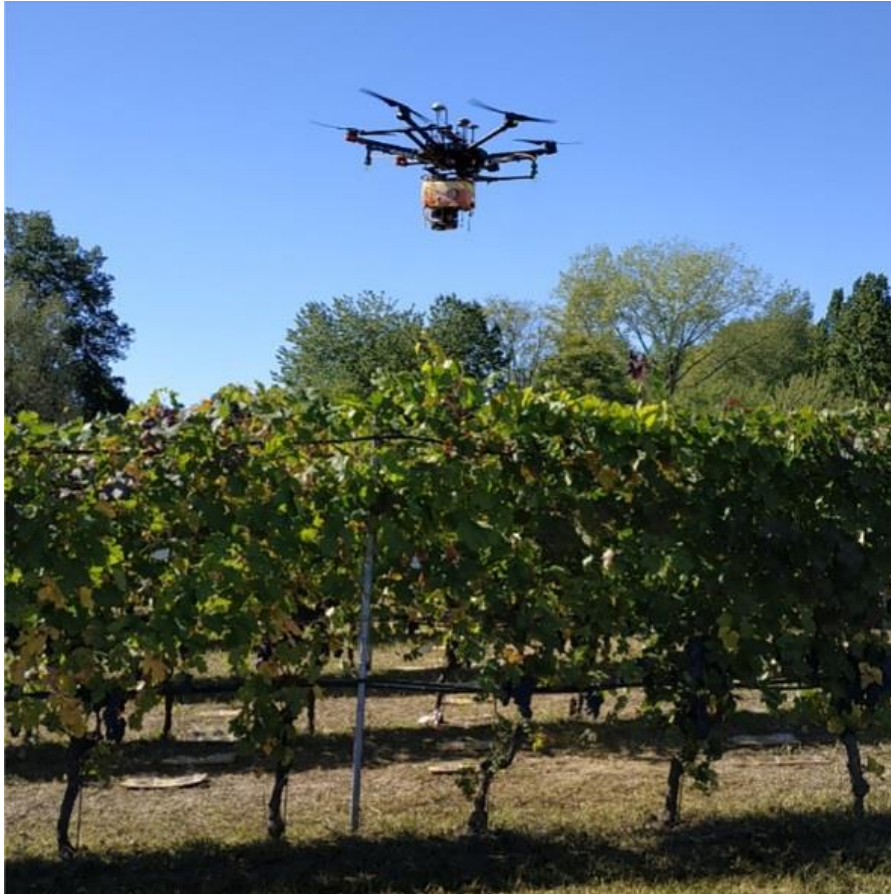
Slika 9.2. Беспилотна летјелица DJI Matrice 600 Pro s prilagoђenom prskalicom Izvor: Biglia i sur. (2022)
