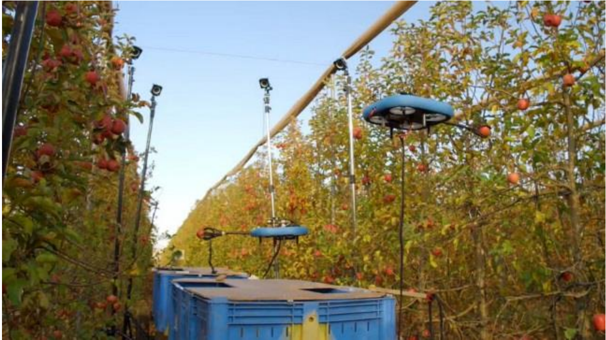
Slika 8.8. Autonomni dronovi Tevel Aerobotics Technologies s pripadajućom autonomnom platformom
