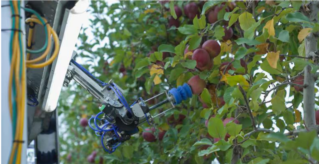
Slika 8.6. Robotski berač jabuka tvrtke Advanced Farm
