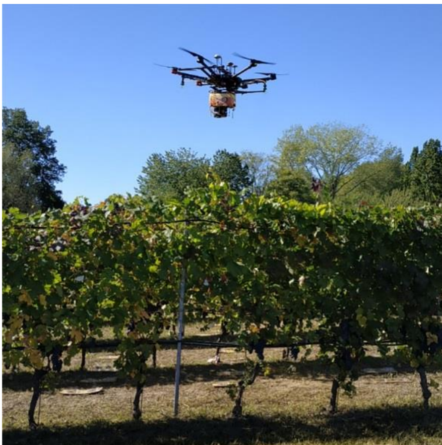
Slika 9.2. Беспилотна летјелца DJI Matrice 600 Pro s prilagoђenom prskalicom Izvor: Biglia i sur. (2022)
