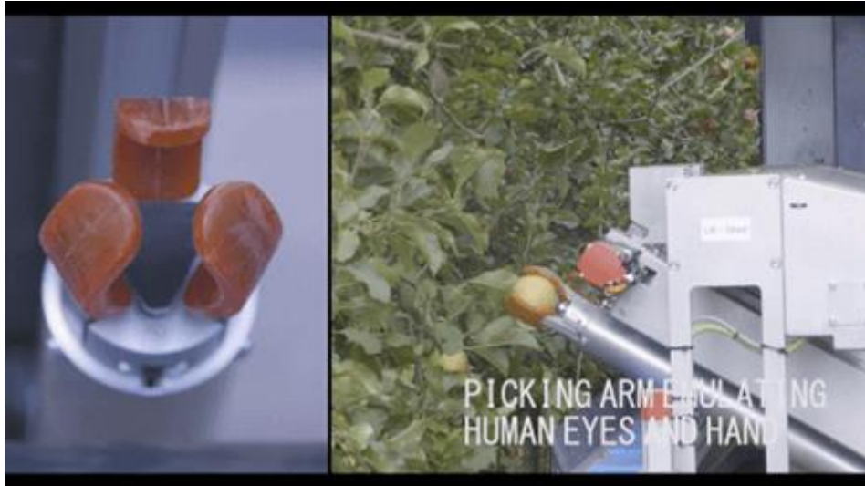
Slika 8.5. Hvataljka i robotska ruka autonomnog berača voća FFRobot
