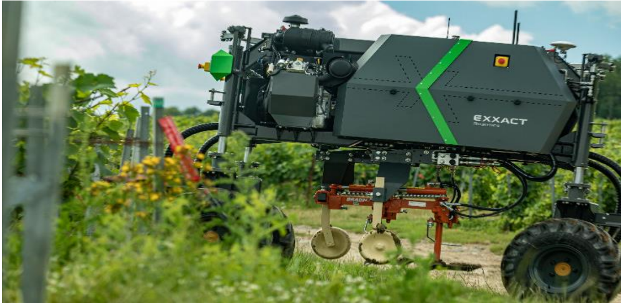
Slika 3.9. Robot prejahivač Traxx
