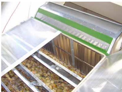
Slika 8. Upotreba solarne sušilice pri sušenju plodova smokva.
