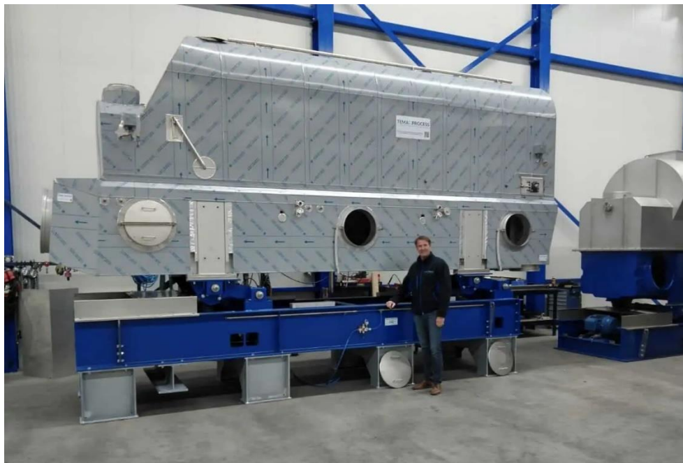
Slika 4.1.1. Stroj za tretiranje sjemena vrućim zrakom
