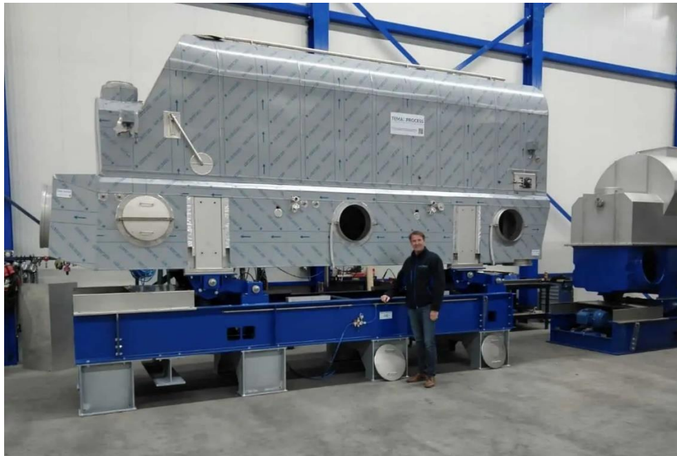
Slika 4.1.1. Stroj za tretiranje sjemena vrućim zrakom
