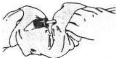
Slika 4. A) Umetanje staklene cijevi ili termometra u čep i B) izvlačenje staklene cijevi iz čepa
