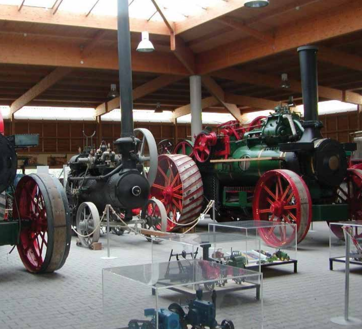
Fotografije 120. i 121. S parnim strojevima koji su bili fiksni na dva kraja parcele (gore), povezani čeličnom sajlom s plugovima koji su vučeni naprijed nazad oralo se na Belju od 1870. godine pa do zadnje obrade parnim strojem 1958. godine (dolje)
