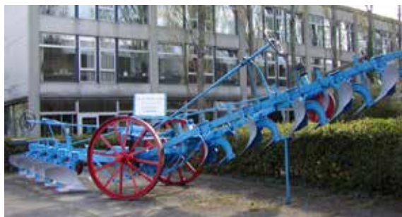
Fotografije 120. i 121. S parnim strojevima koji su bili fiksni na dva kraja parcele (gore), povezani čeličnom sajлом s plugovima koji su vučeni naprijed nazad oralo se na Belju od 1870. godine pa do zadnje obrade parnim strojem 1958. godine (dolje)
