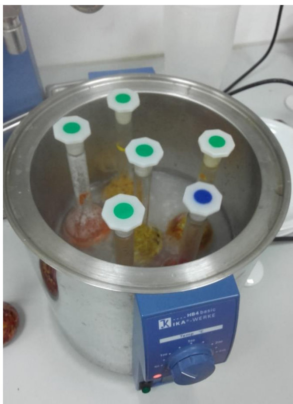
Slika 15: Prikaz kuhanja uzoraka u parnoj kupelji
