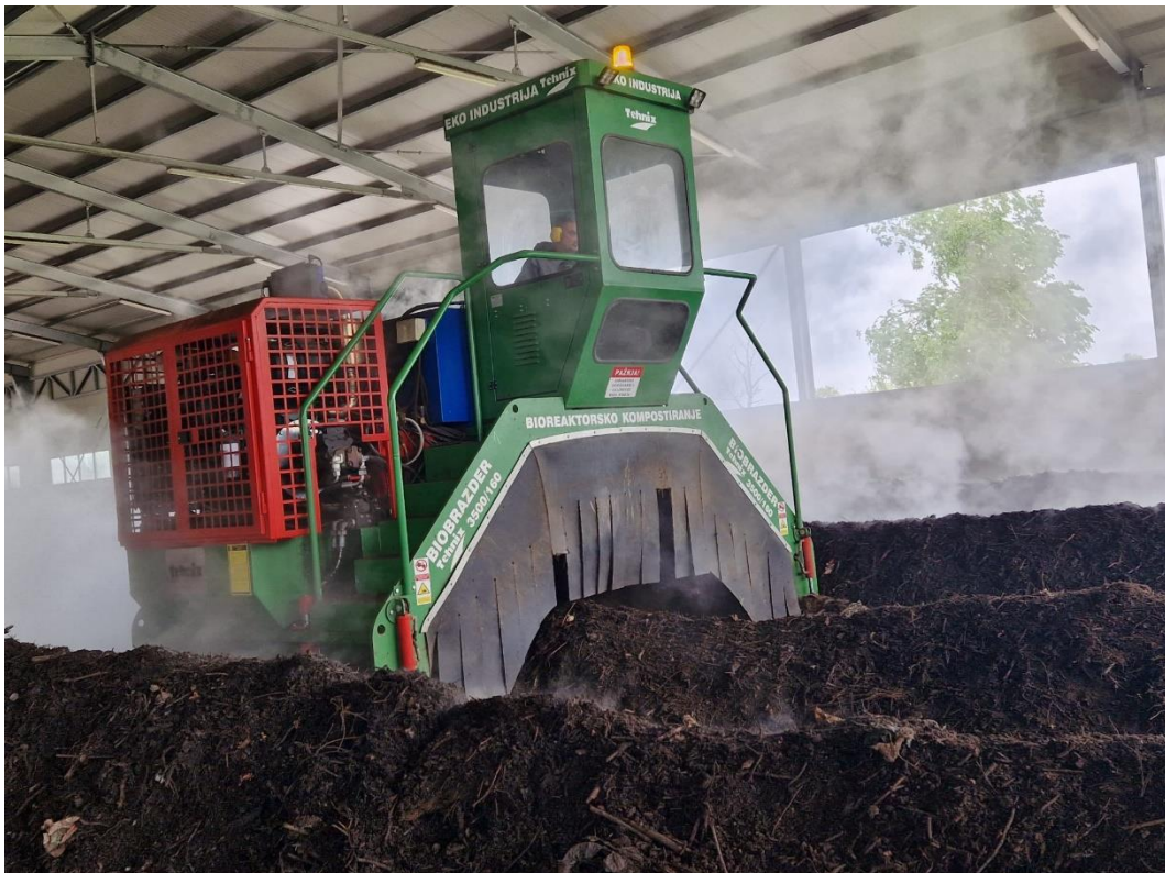
Slika 16. Prikaz strojnog miješanja komposta Izvor: E. Nekret-Katić, 2023.
