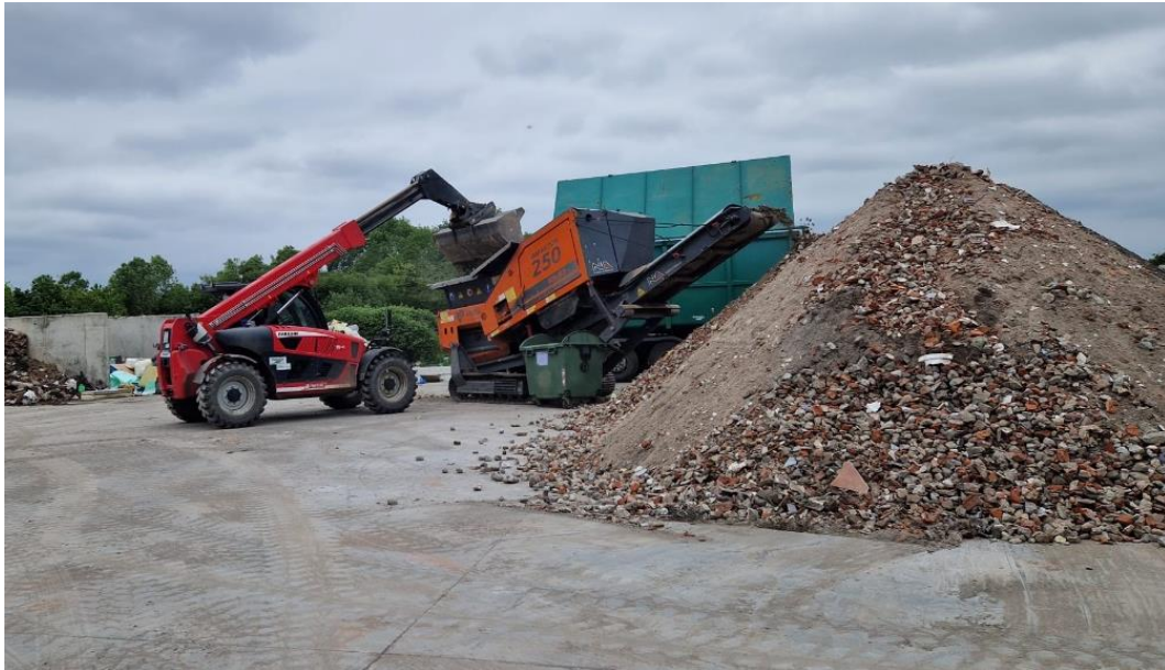
Slika 14. Prikaz usitnjavanja građevinskog otpada Izvor: E. Nekret-Katić, 2023.
