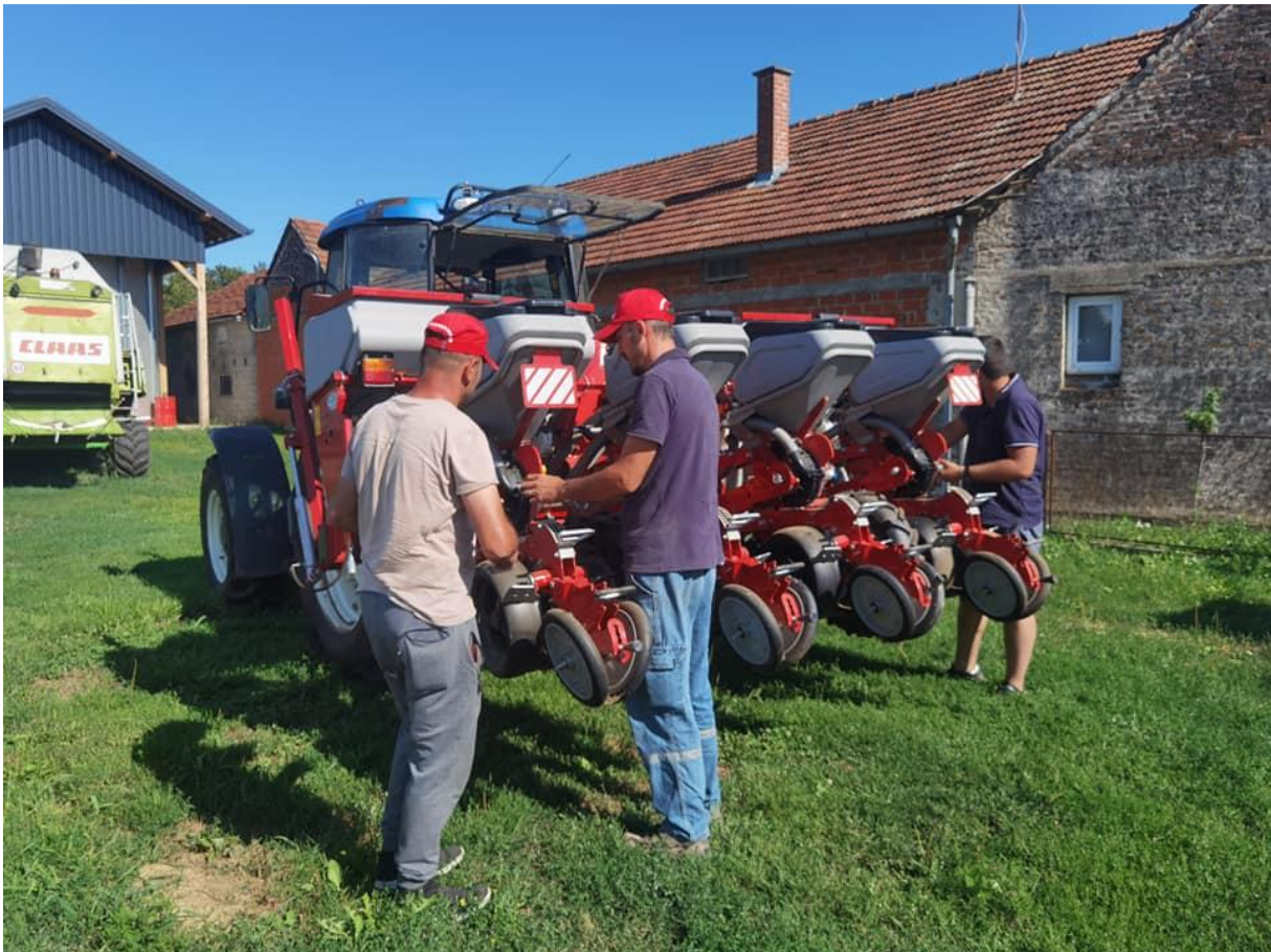
Slika 2.1. Servisno-preventivno održavanje pneumatske sijačice prije sjetve kukuruza
