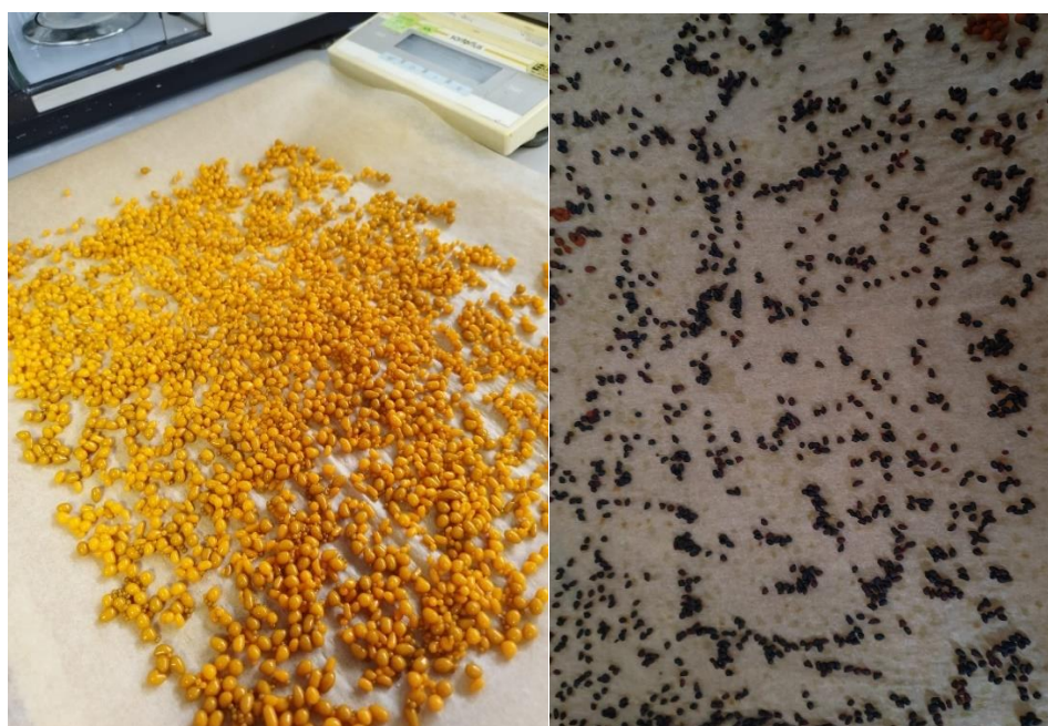
Slika 3.2.2. Mokre mikrokapsule (lijevo); suhe mikrokapsule (desno) ekstrakta karotenoida kadifice
