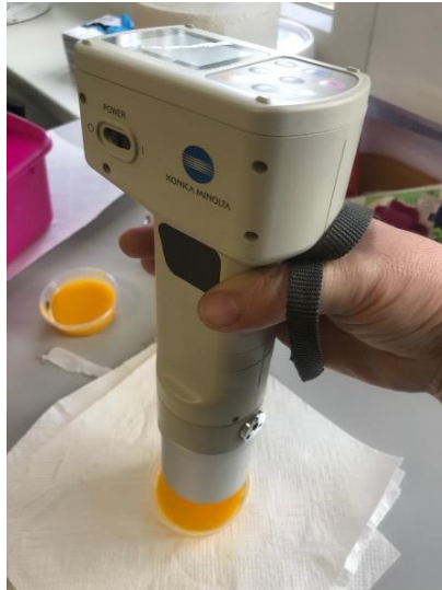
Slika 3.5.1. Određivanje boje žutanjka prema CIE L*a*b* kromametrom Minolta CR-410
