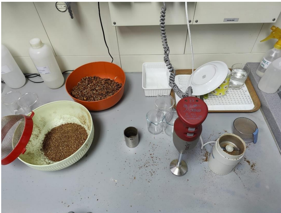
Slika 6. Usitnjavanje ljuske lješnjaka i priprema praha
