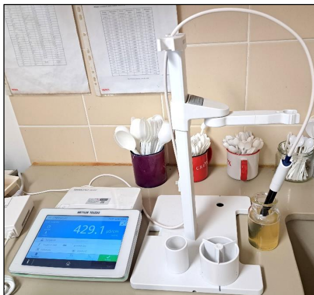
Slika 9. Utvrđivanje električne provodnosti pomoću konduktometra
