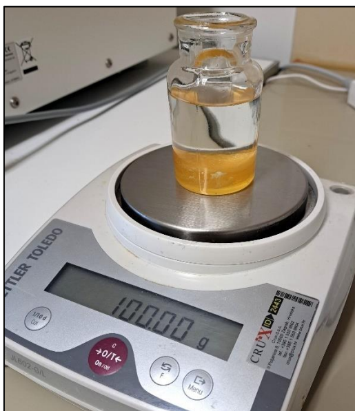
Slika 8. Priprema uzorka meda za utvrđivanje električne provodnosti
