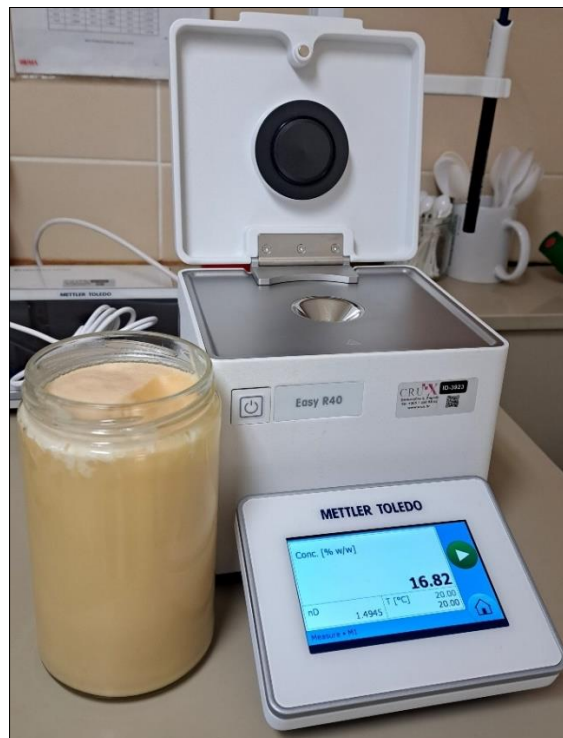
Slika 7. Utvrđivanje udjela vode stolnim refraktometrom
