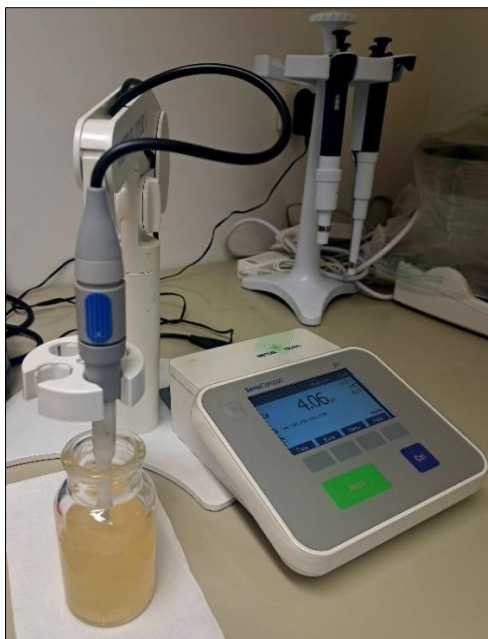
Slika 10. Određivanje pH vrijednosti meda od bršljana
