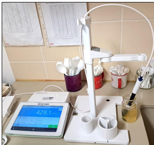
Slika 9. Utvrđivanje električne provodnosti pomoću konduktometra
