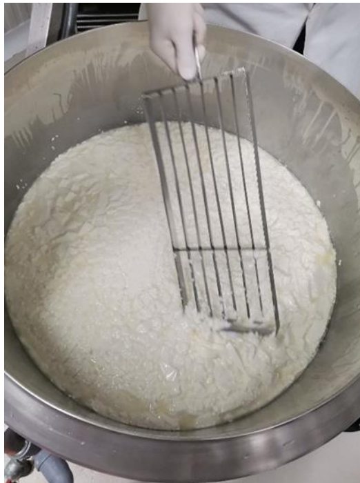
Slika 3.1.3. Rezanje gruša sirarskom harfom
