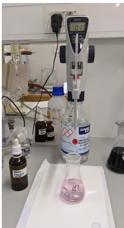
Slika 11. Titracija za određivanje hlapljive kislosti uz indikator fenolftalein
