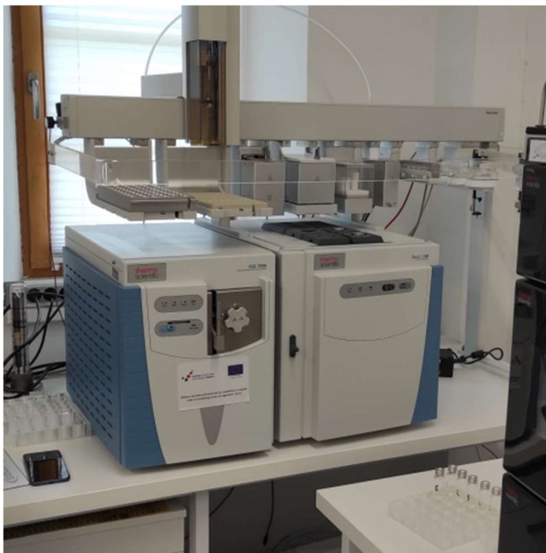
Slika 16. Uređaji plinska kromatografija i spektrometar masa korišteni za analizu hlapljivih aromatskih spojeva
