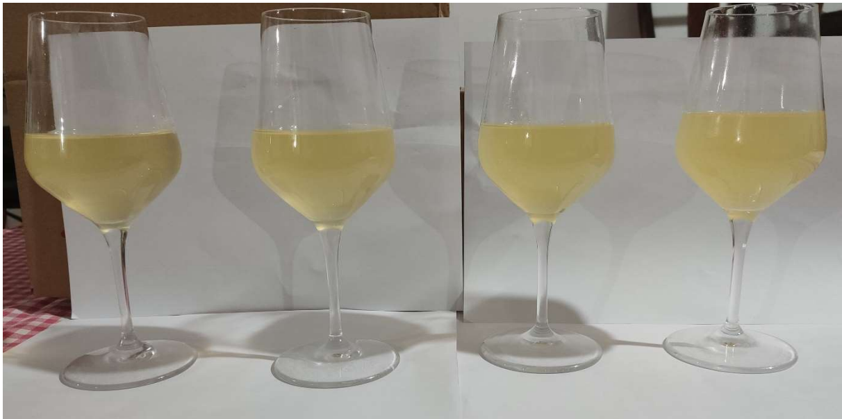
Slika 12. Razlike u mutnoći mošta s lijeva 50 (NTU) na desno 300 (NTU)
