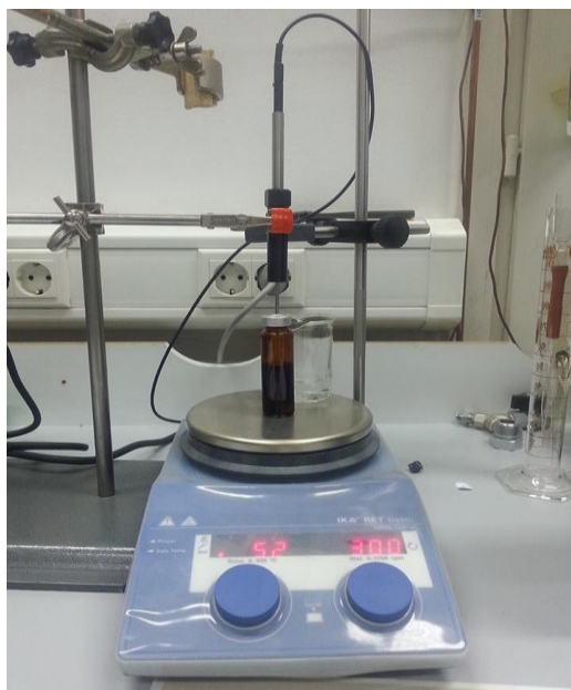
Slika 18. Priprema uzorka za analizu na magnetnoj miješalici
