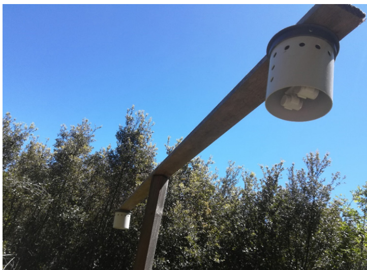
Slika 1. Pasivni mjerači ozona na plohi Šišan
