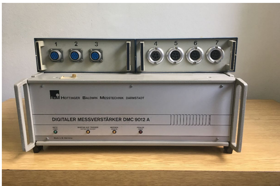
Slika 12. 7-kanalno digitalno pojačalo DMC 9012 A (1991). Foto S. Košutić
