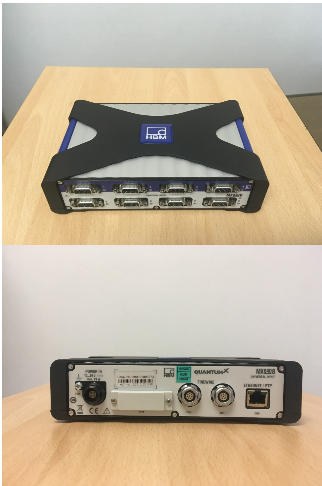
Slika 13. 8-kanalo digitalno pojačalo HBM Quantum X (2018). Foto S. Košutić
