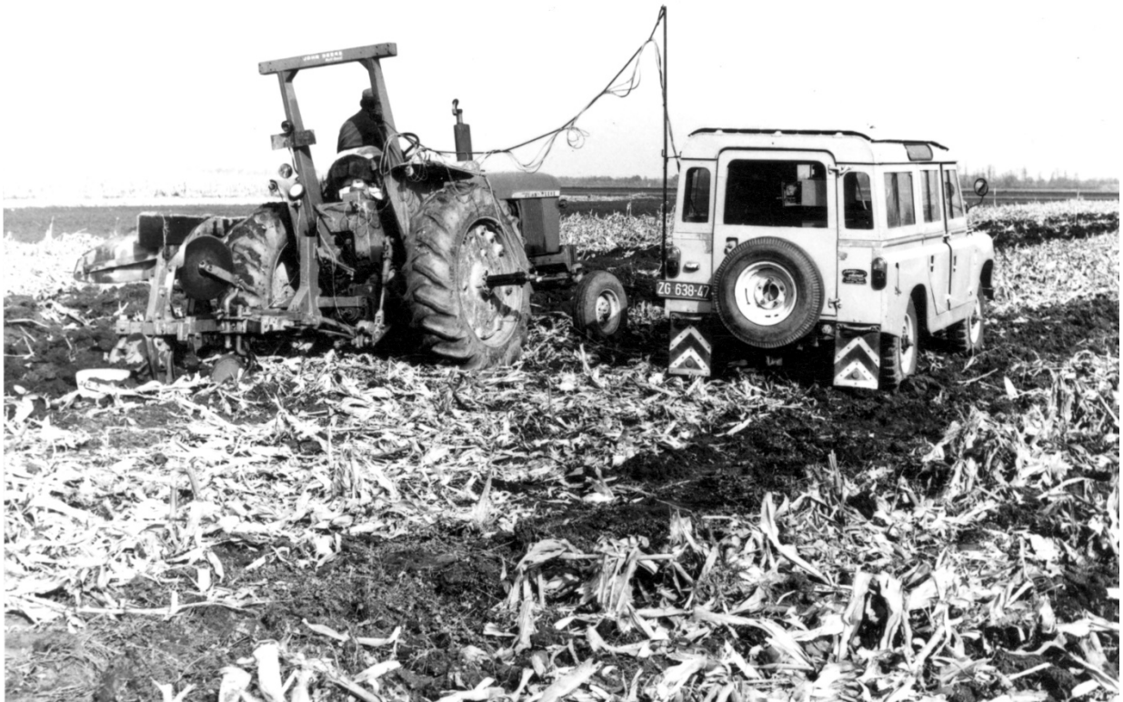
Slika 24. Mjerenje vučnog otpora oranja (1970-ih)
