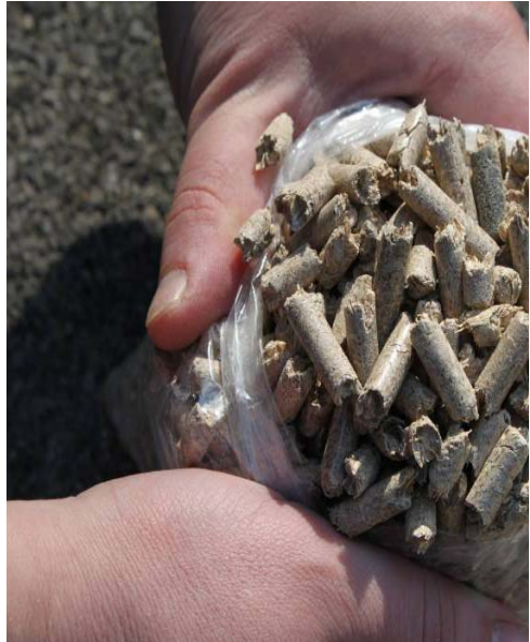
Slika 60. M x giganteus u obliku peleta
