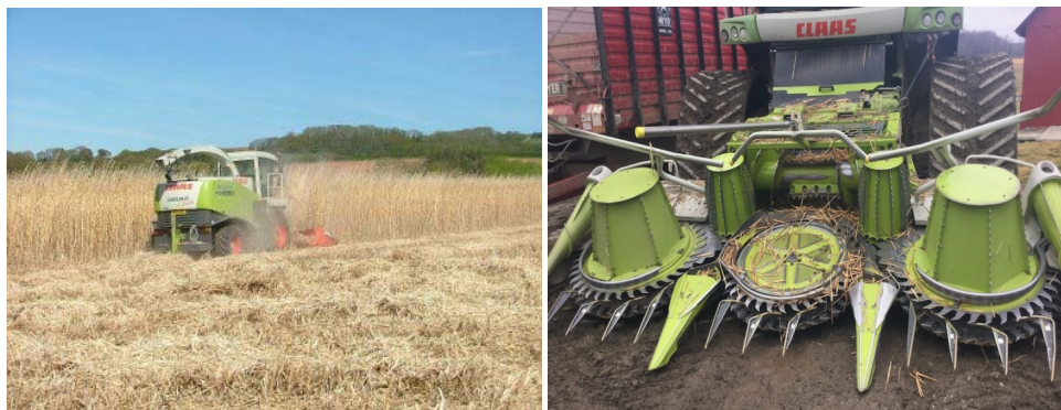
Slika 50. Samokretni kombajn opremljen hederom s rotirajućim nazubljenim valjcima ( http://www.farmanddairy.com/top-stories/tour-gives-look-at-miscanthus-potential/322446.html )
