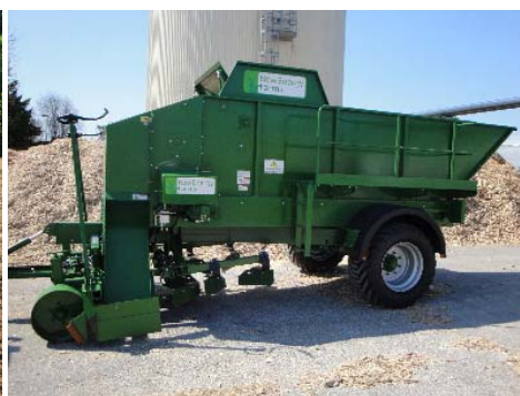
Slika 35. Specijalna automatska sadilica rizoma ( www.newenergifarms.com )
