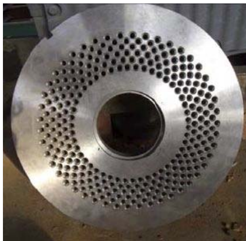
Slika 61. Matrica za formiranje peleta u peletirki ( www.termis.weebly.com )
