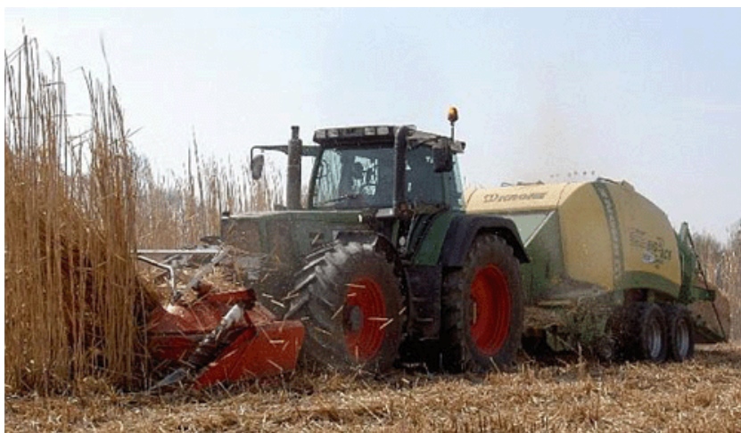
Slika 53. Kombinirani agregat s uređajem za košnju i baliranje (jednofazna žetva jednim agregatom) ( www.biowatt.hu )
