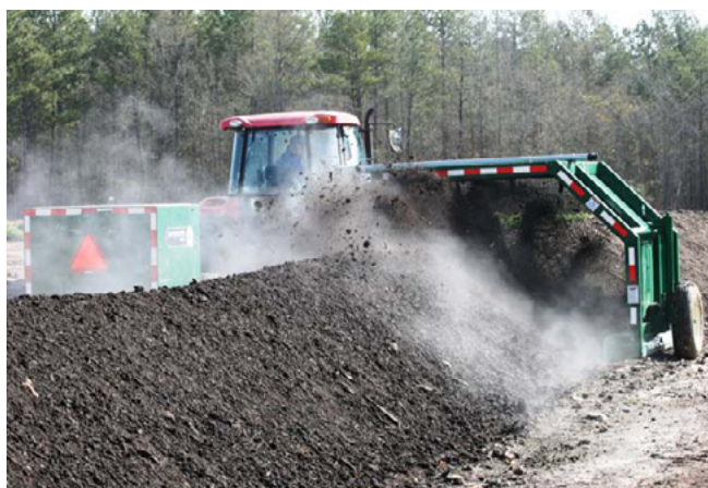
Slika 53. Obrada mulja tijekom kompostiranja na otvorenom ( www.climatesmartglaciercountry.org )
