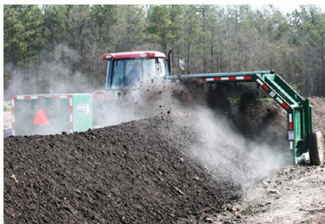
Slika 53. Obrada mulja tijekom kompostiranja na otvorenom
