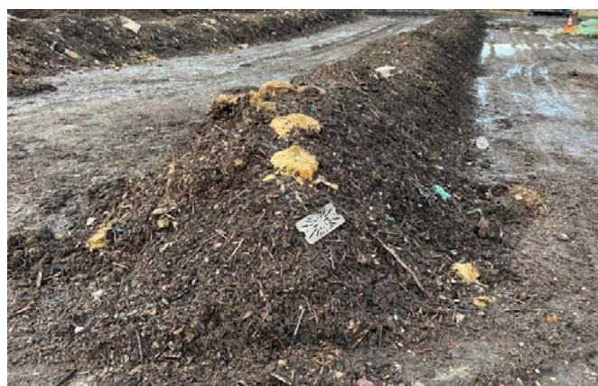
Slika 52. Kompostiranje mulja na otvorenom ([www.sludgeprocessing.com](http://www.sludgeprocessing.com))
