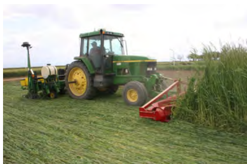
Slika 1. Istovremeno valjanje nadzemne mase i sjetva kulture
