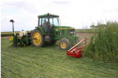
**Slika 1.** Istovremeno valjanje nadzemne mase i sjetva kulture
