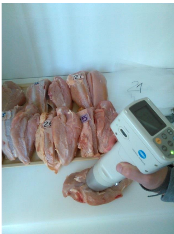
Slika 6. Mjerenje pokazatelja boje (izvor: vlastito istraživanje)
