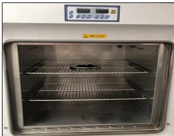
Slika 3.4.3. Uzorci trčaka u sušioniku
