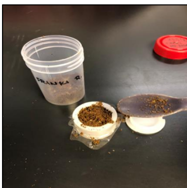
Slika 3.4.4. Priprema uzoraka za kemijsku analizu: (lijevo) osušeni uzorci trčaka; (sredina) ispunjena mjernog cilindra uzorkom; (desno) smještanje uzorka u mjernu radnu postaju s mjernim instrumentom (Vanta C Olympus analizator)
