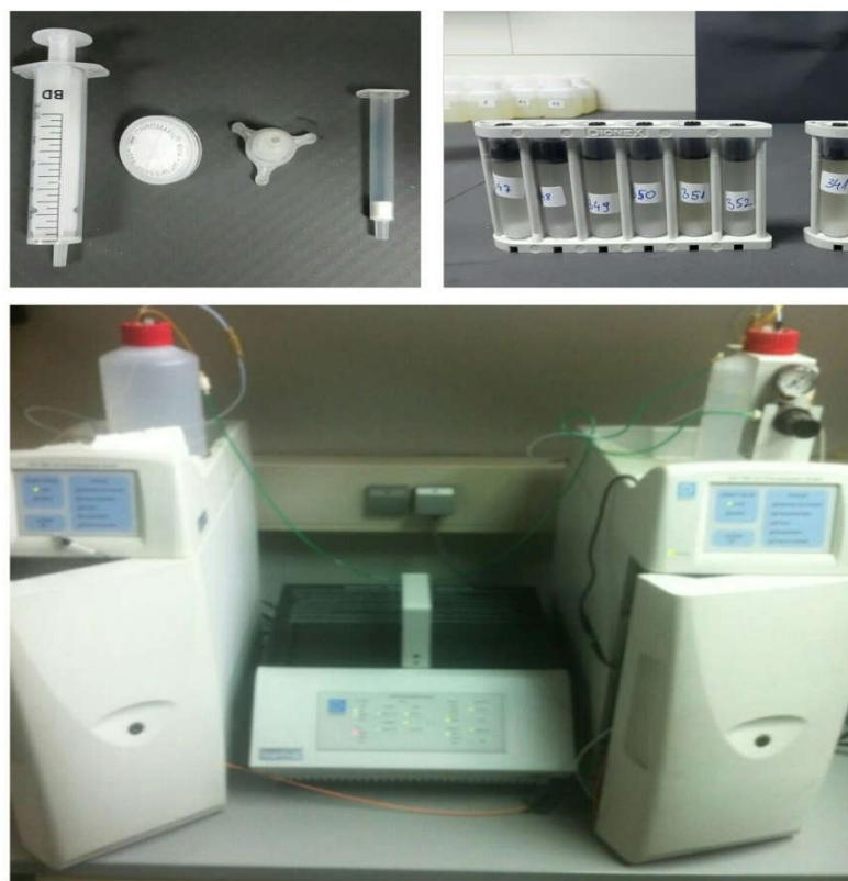
Slika 7. Cartridge (OnGuard IIP), ekstrakt tla spreman za analizu, sustav ionske kromatografije
