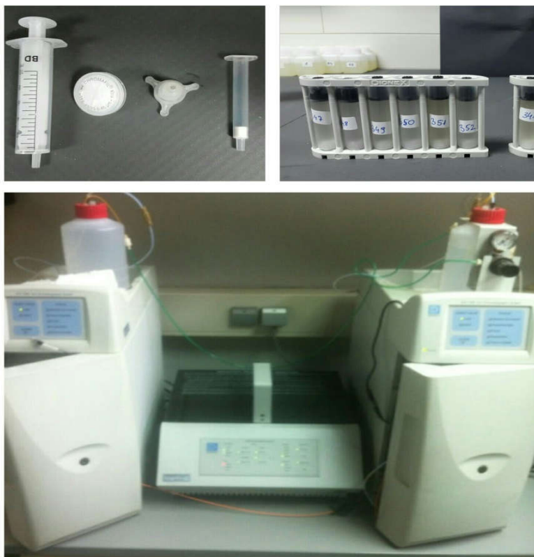
Slika 7. Cartridge (OnGuard IIP), ekstrakt tla spreman za analizu, sustav ionske kromatografije Foto: Marić, 2015.
