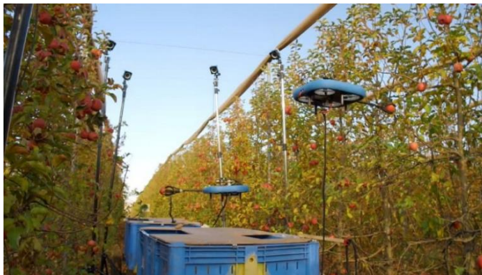
Slika 10. Autonomna platforma za branje jabuke Izvor: https://www.agroklub.com
