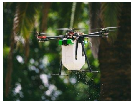
Slika 7. Bug Drone tijekom aplikacije prirodnih neprijatelja štetnika Izvor: https://www.uq.edu.au
