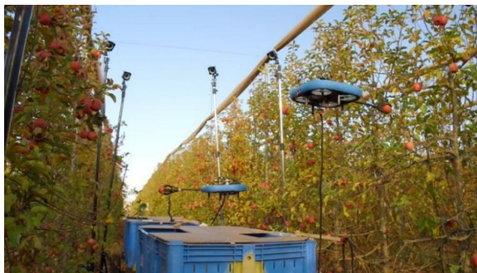
Slika 10. Autonomna platforma za branje jabuke Izvor: https://www.agroklub.com
