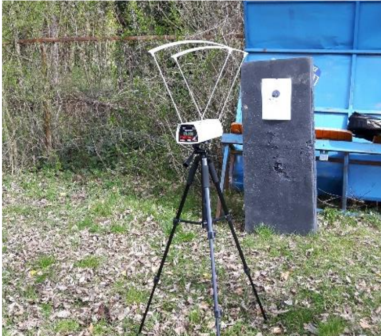
Slika 27. Mjerenje brzine kronografom (foto: K. Kavčić)
