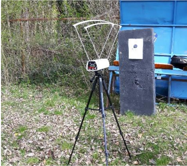
Slika 27. Mjerenje brzine kronografom (foto: K. Kavčić)
