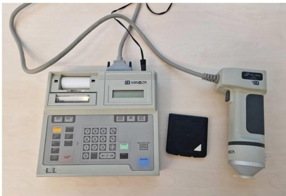
Slika 22. Minolta CR-300 kolorimetra (Izvor: Z. Kralik)
