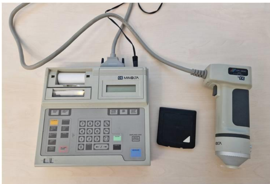
Slika 22. Minolta CR-300 kolorimetra (Izvor: Z. Kralik)
