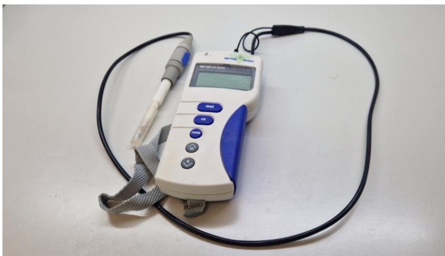
Slika 20. Digitalni pH-metar Mettler MP120-B (Izvor: Z. Kralik)
